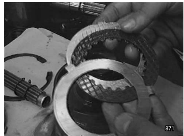
Fig. 43 - Extraire les deux disques d'appui avec le disque de frein.
