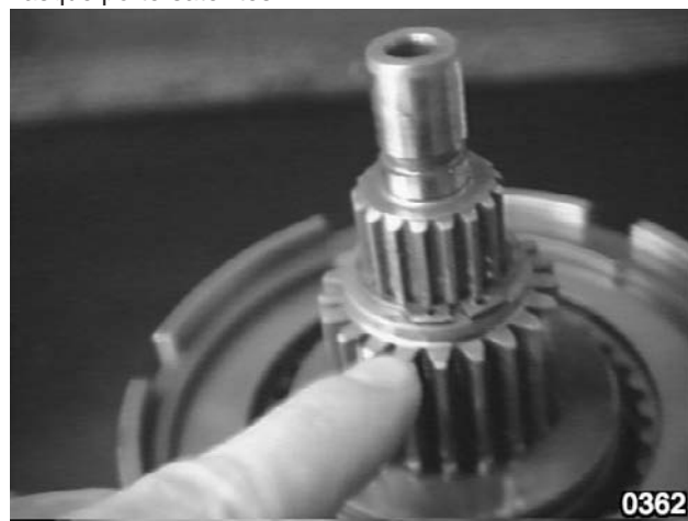
Fig. 20 - Pour la séparation de Powershift, déposer le circlip représenté sur la figure.
