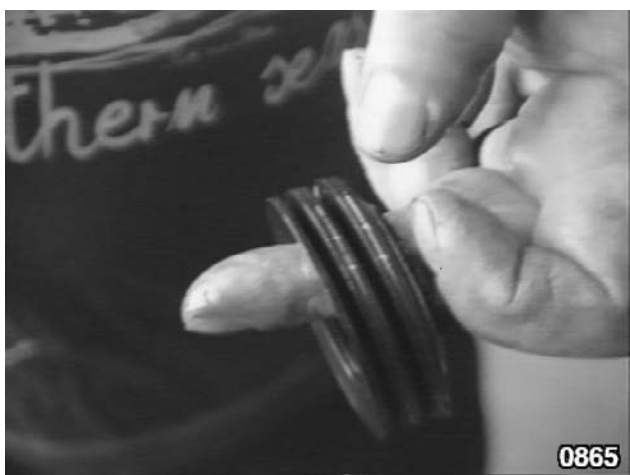
Fig. 61 - Séquence de montage des 5 rondelles Belleville.
