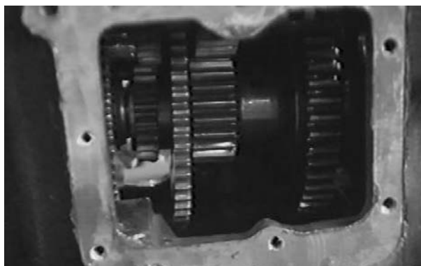
Fig. 45 - Engrenages sur l'arbre du réducteur de gammes.
