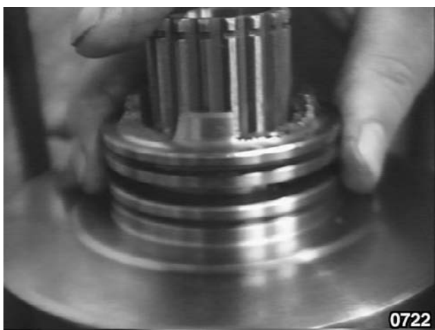
Fig. 51 - Segments d'étanchéité "type VESPEL" de la cloche de l'embrayage HIGH.
