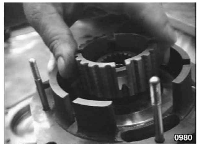
Fig. 79 - Monter ensuite le moyeu de l'embrayage et mettre en place le deuxième circlip.
