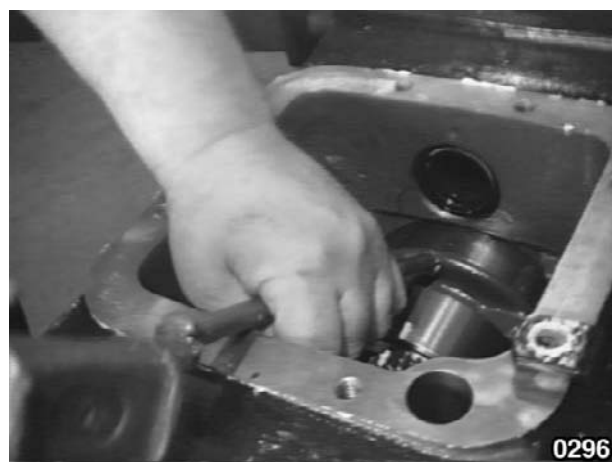
Fig. 14 - Frapper à l'aide d'un pointeau comme représenté sur la figure pour dégager Powershift par l'avant du carter de boîte.
