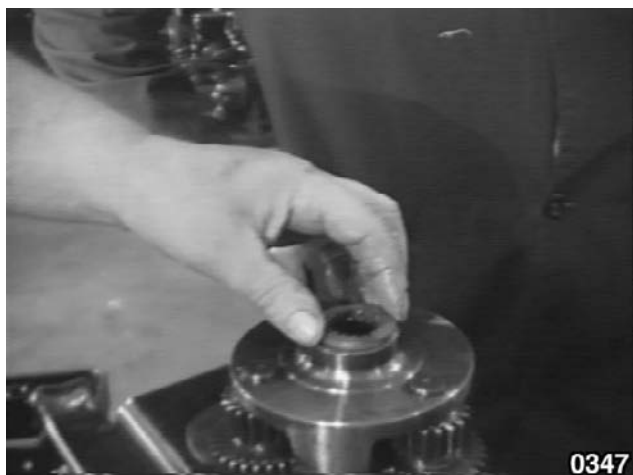
Fig. 19 - La cale de réglage du jeu des arbres de Powershift est intercalée entre la cloche et le réducteur épicycloïdal.
