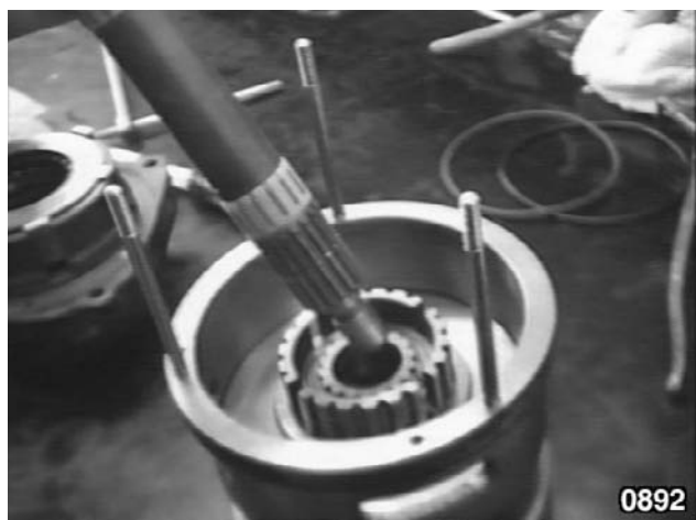
Fig. 70 - Assembler l'embrayage "HIGH". Monter le roulement muni de ses joncs dans la cloche de l'embrayage "MEDIUM", monter le moyeu en le fixant avec son circlip et placer les 3 circlips de service dans la cloche. Monter le piston après avoir mis en place les joints toriques sur celui-ci.
