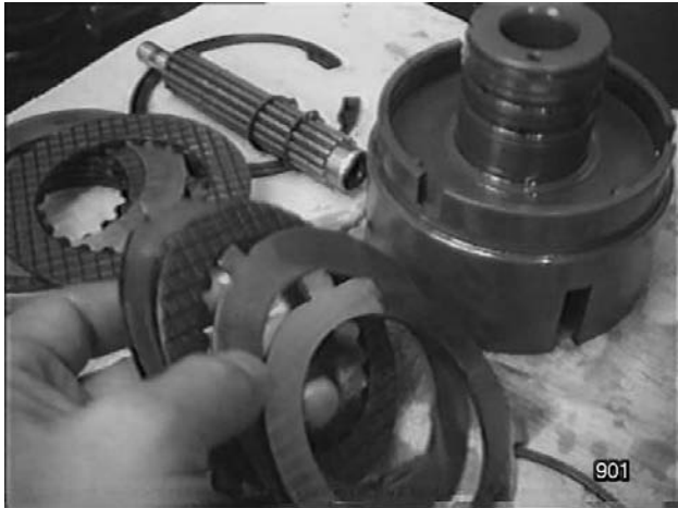
Fig. 44 - Contrôler l'état du jeu de disques de frein.
