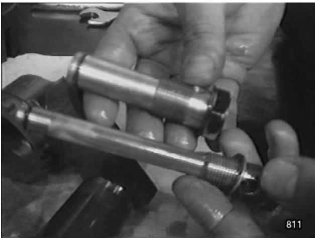
Fig. 40 - Désaccoupler les deux raccords d'alimentation d'huile et les contrôler visuellement.
