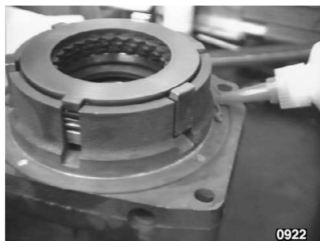
Fig. 73 - Enduire de Loctite 510 la surface de la cloche comme le montre la figure. REMARQUE: lors de l'application de la pâte d'étanchéité prenez soin de ne pas salir les orifices d'alimentation d'huile à l'embrayage.
