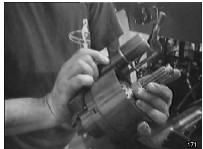
Fig. 19 - Débrancher les tuyaux d'alimentation d'huile et extraire du carter de boîte l'ensemble embrayage complet de la P.d.F.
