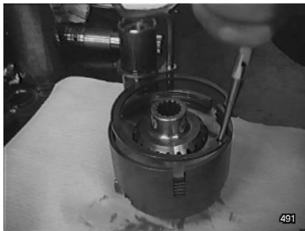
Fig. 23 - Déposer le circlip de retenue des disques de l'embrayage.
