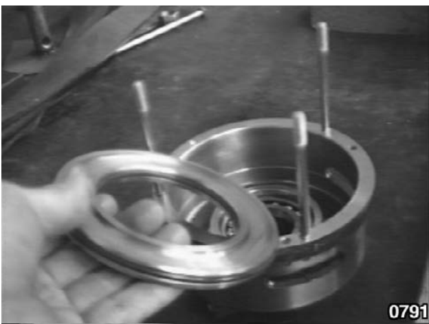
Fig. 57 - Contrôler l'état du joint d'étanchéité du piston de la cloche de l'embrayage de la gamme "MEDIUM".
