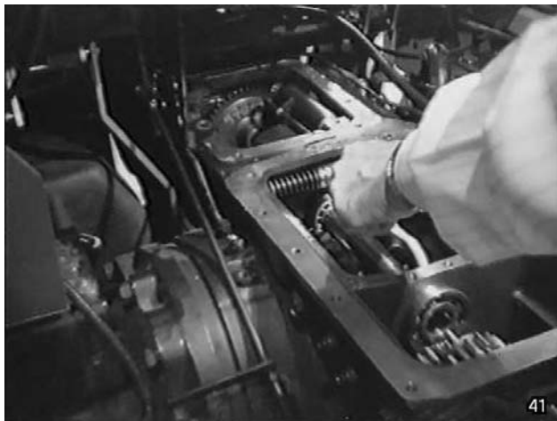
Fig. 16 - Dégager l'arbre arrière de la P.d.F. vers la partie arrière.
