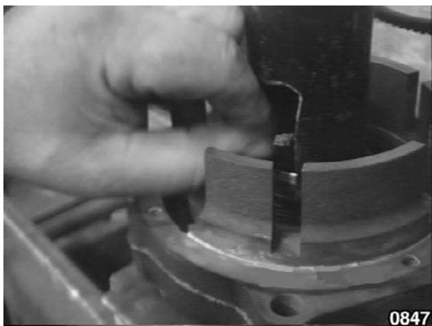
Fig. 59 - Déposer le circlip d'arrêt des ressorts.
