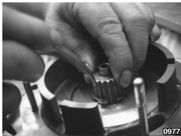
Fig. 78 - Monter l'embrayage des vitesses "LOW" en plaçant d'abord le circlip sur l'arbre comme le montre la figure.
