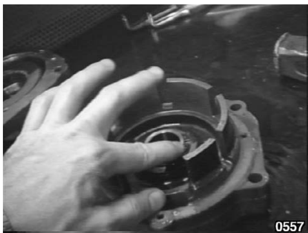
Fig. 39 - Ce piston peut être dégagé en déposant le circlip d'arrêt des ressorts de rappel du piston placé du côté opposé à la cloche.
