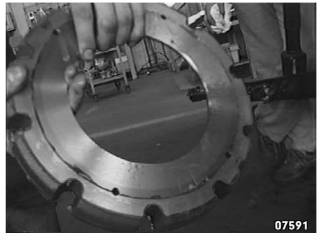
Fig. 13 - Monter la rondelle d'appui du disque du frein. La face de la figure doit être placée au contact du disque du frein.
