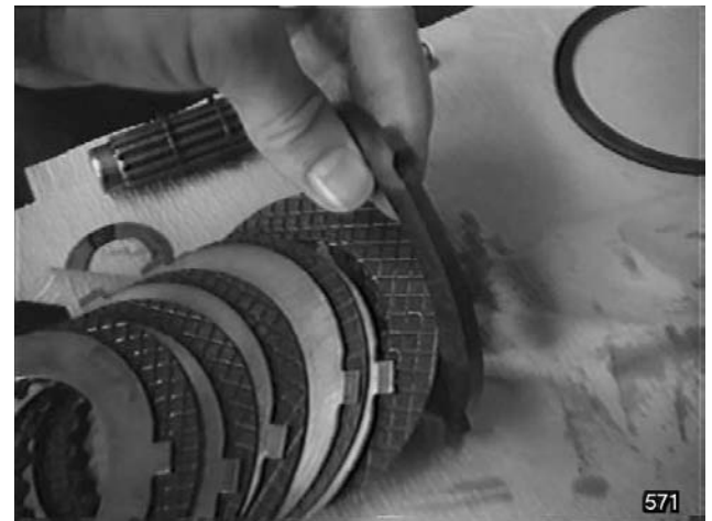
Fig. 29 - Contrôler l'état de la contre-plaque de l'empilage complet des disques de l'embrayage.
