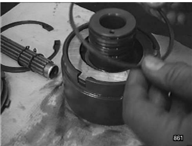
Fig. 42 - Déposer le circlip de retenue de la rondelle d'appui du disque de frein.
