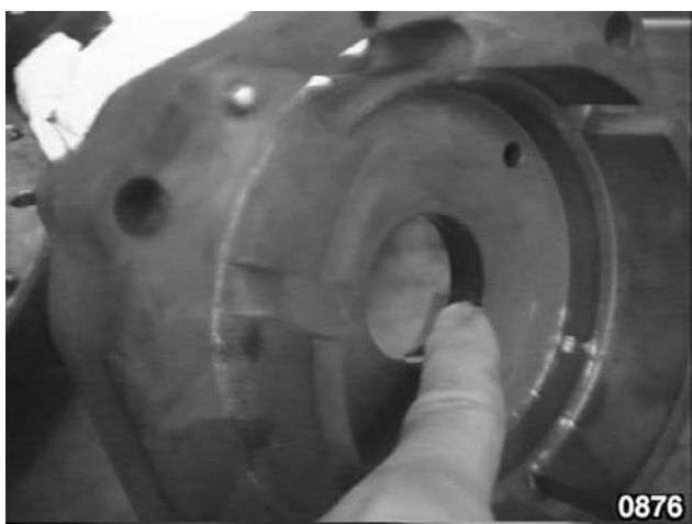
Fig. 63 - Gorge de logement du joint torique dans la cloche de l'embrayage "LOW".
