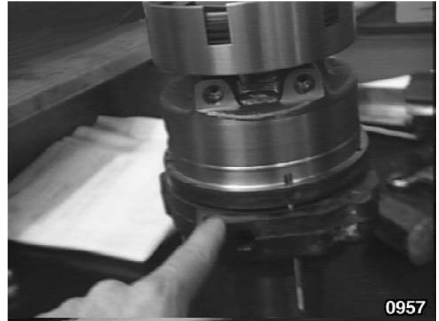
Fig. 77 - Après l'accouplement, on remarquera la présence d'une lumière entre les deux cloches, qui est due à la précontrainte que subiront les rondelles-ressorts au moment du serrage des vis.
