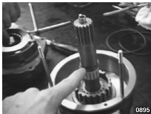
Fig. 71 - Monter l'arbre LOW muni de ses roulements à rouleaux et mettre en place l'anneau élastique.
