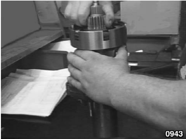
Fig. 76 - Lors de l'accouplement des deux cloches, les goujons (prisonniers) s'engagent dans trois alésages de sorte que les parties doivent nécessairement s'unir correctement. Tourner l'arbre pendant l'accouplement des cloches de manière à centrer les disques de l'embrayage.
