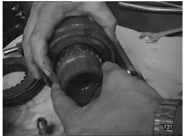
Fig. 35 - Déposer le collecteur d'alimentation d'huile à l'embrayage.
