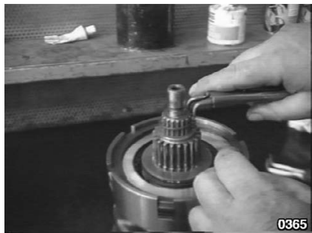
Fig. 21 - Déposer le circlip représenté sur la figure à l'aide d'un pince à circlips.
