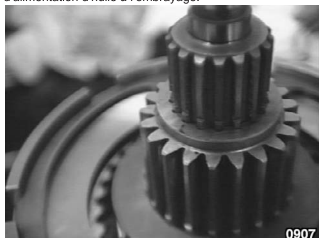
Fig. 75 - Monter la bague de l'embrayage "MEDIUM" avec les dégagements orientés vers le circlip.
