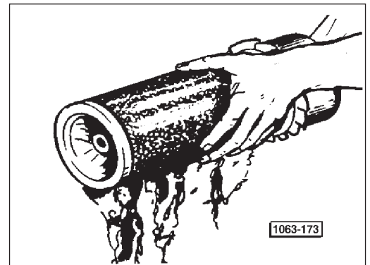
Fig. 13 - Elimination des résidus d'impuretés sur la cartouche par jet d'eau.
