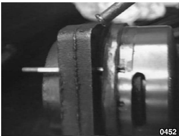
Fig. 33 - Frapper à l'aide d'un pointeau sur la cloche MEDIUM-LOW pour la séparer du reste du groupe.
