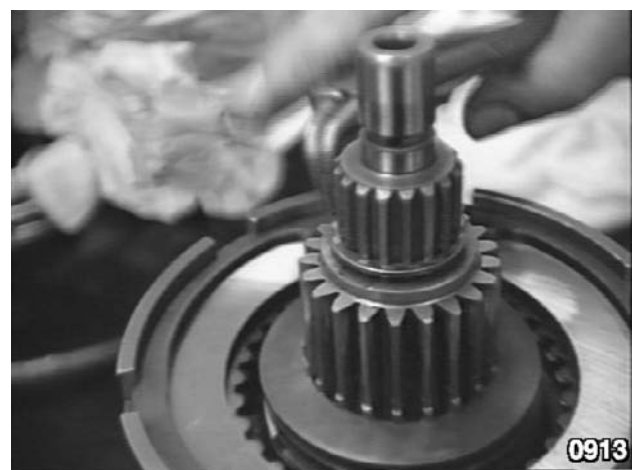
Fig. 74 - Monter le circlip et contrôler que l'arbre présente un certain jeu.
