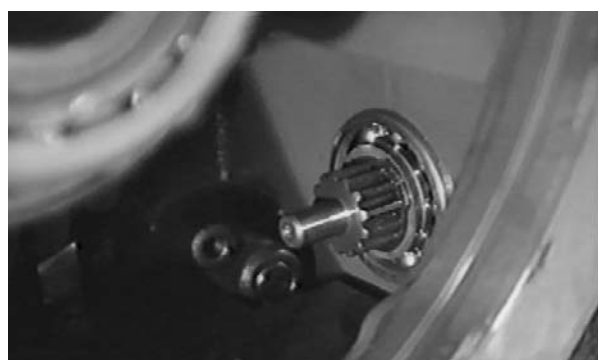
Fig. 44 - Dépose du circlip de maintien de l'arbre.
