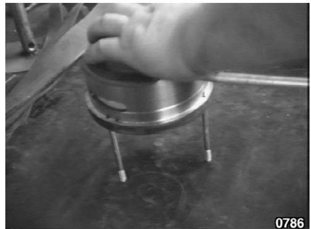
Fig. 56 - Dégager le piston de la cloche de l'embrayage de la gamme "MEDIUM".
