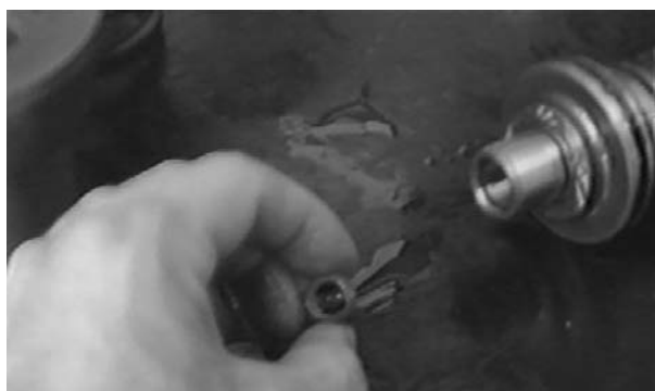
Fig. 43 - Dépose du moyeu de la P.d.F. syncro.
