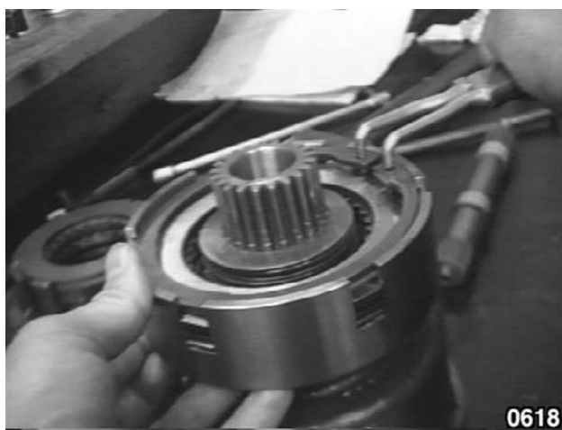
Fig. 44 - Déposer le circlip d'arrêt des disques de l'embrayage "HIGH".
