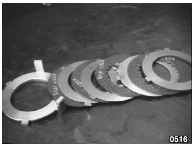
Fig. 37 - Disques de l'embrayage "MEDIUM" (4 disques d'embrayage+3 contre-plaques+2 entretoises).
