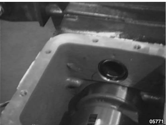
Fig. 70 - Joint d'étanchéité de l'arbre interposé entre l'embrayage et la boîte de vitesses. Ce joint peut être remplacé en accédant par l'intérieur du carter de boîte avant.
