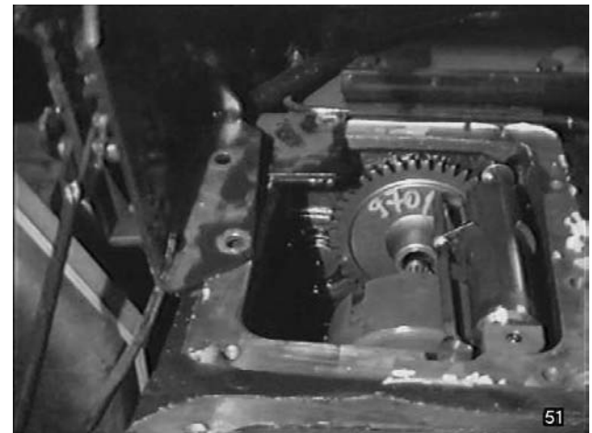
Fig. 17 - Déposer le circlip sur l'arbre avant de l'embrayage.
